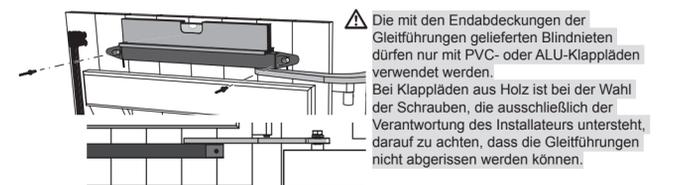
⚠ Die mit den Endabdeckungen der Gleitführungen gelieferten Blindnieten dürfen nur mit PVC- oder ALU-Klappläden verwendet werden. Bei Klappläden aus Holz ist bei der Wahl der Schrauben, die ausschließlich der Verantwortung des Installateurs untersteht, darauf zu achten, dass die Gleitführungen nicht abgerissen werden können.
