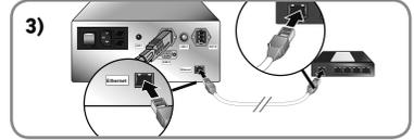
4) Schließen Sie ein zweites "RJ45"-Kabel an den Ethernet-Anschluss des "Ethernet-Hub" und den Ethernet-Anschluss des "EMS2 Touch Panel" an.
