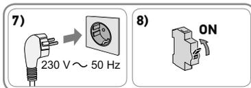
Les prises secteur doivent être installées à proximité de chaque élément de l'équipement et doivent être aisément accessibles.
