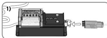
2) Sluit het kabeluiteinde met de mannelijke "Hirschmann"-stekker aan op de linkse of rechtse vrouwelijke "Hirschmann"-uitgang van de "EMS2 DWP Power Box".
