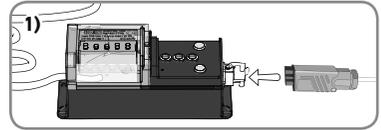
2) Brancher le câble côté prise «Hirschmann» mâle à la sortie femelle «Hirschmann» droite ou gauche du boîtier «EMS2 DWP Power Box».
