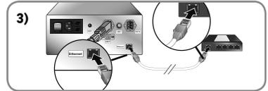
4) Connecter un second câble «RJ45» entre les ports ethernet du «HUB ethernet» et le «EMS2 Touch Panel».
